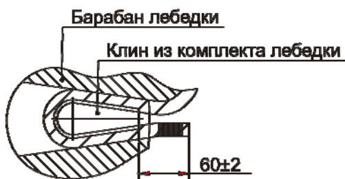
Крепление каната на барабане лебедки
